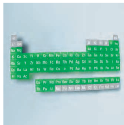
Диапазон определяемых элементов от фтора до урана
